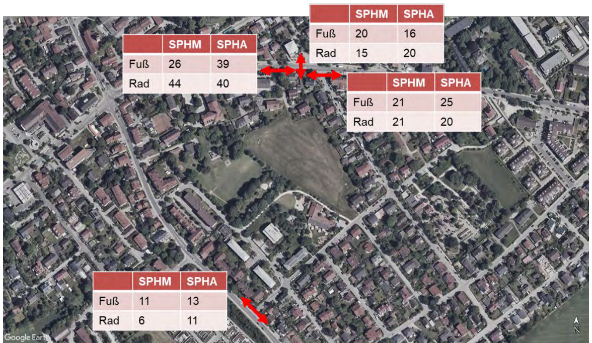
Abbildung 8: Erhobene Fuß- und Fahrradströme (auf dem Gehweg) in den Spitzenstunden [Quelle Hintergrund: Google Earth Pro]
